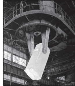
125. Wyciąganie gorącego wlewka z pieca wglębego na Zgniataczu
